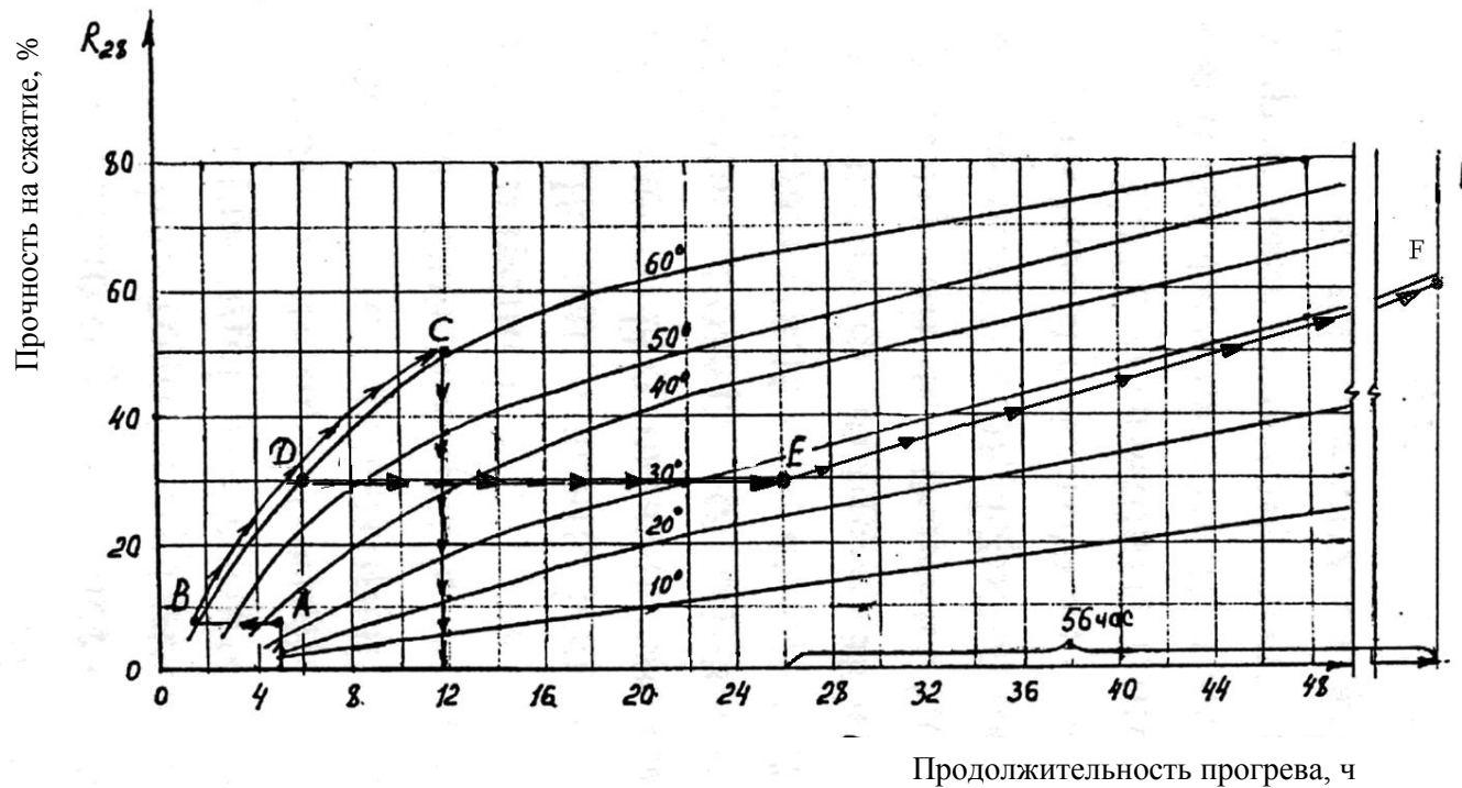
Рис. 1. Интенсивность нарастания прочности бетона марки 200 на портландцементе при различных температурах изотермического прогрева
